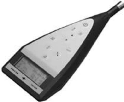
**Fonometro integratore:** consente di misurare la variazione di pressione sonora dovuta ad un evento e di effettuare l'analisi in frequenza (filtro a 1/1 o a 1/3 ottava).
